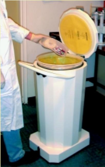
Biologisch kontaminierte Abfälle werden direkt am Ort ihres Entstehens im autoklavierbaren Deckelsack gesammelt. Die Desa-Trans-Säule ermöglicht dabei ein optimales Handling. Durch die Fußbetätigung bleiben die Hände frei und somit die Säule selbst unkontaminiert. Der Deckel schließt hydraulisch gedämpft, um eine unnötige Kontamination der Umgebungsluft durch Verwirbelungen auszuschließen.
