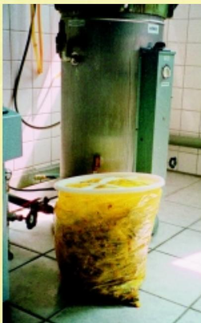
Nach dem Abkühlen kann der Deckelsack am integrierten Tragegriff aus dem Autoklaven entnommen werden. Etwaige Flüssigkeitsanteile bleiben auch nach dem Autoklavieren im Deckelsack, so daß der Weitertransport zur Entsorgungsstelle ebenso sauber und hygienisch erfolgen kann. Der entscheidende logistische Vorteil: Durch den Verzicht auf Umbehälter für den hausinternen Transport entfällt deren Desinfektion und Rücktransport zu den Anfallstellen.
