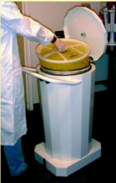
Nach dem Versiegeln wird der Sterilisationsbeutel bequem am integrierten Tragegriff aus der Desa-Trans-Säule herausgenommen und durch einen neuen ersetzt. Die gefüllten und verschlossenen Deckelsäcke werden über die hausinterne Logistik zum Autoklaven gebracht. In den meisten Fällen kann dabei auf einen zusätzlichen Transportbehälter verzichtet werden.
